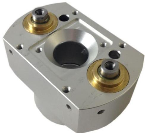
Blocchetto di supporto per gruppo cambio pinza automatico con integrati nel corpo in alluminio n° 2 cilindri Ø 16 mm. corsa 10 mm., doppio effetto.
