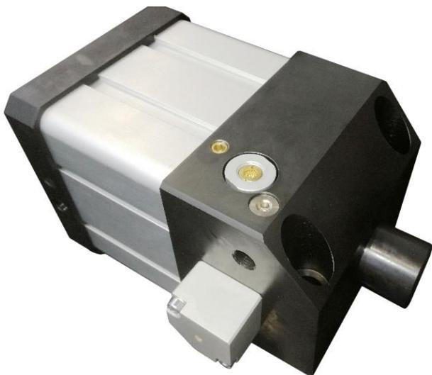
**Attuatore speciale per bloccaggio stampo** integrato con cilindro  $\varnothing$  125 mm. corsa 30 mm., doppio effetto, pistone magnetico, sistema di ammortizzazione pneumatico regolabile per la corsa di rientro, testata in acciaio con stelo in acciaio ad alta resistenza e trattamento termico per ulteriore indurimento superficiale, dispositivo di sicurezza per blocco dello stelo in posizione estesa.
