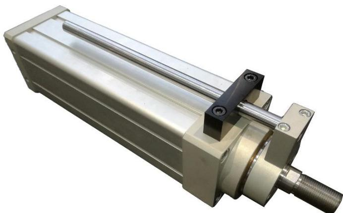
**Cilindro telescopico** a doppio sfilamento. Primo stadio  $\varnothing$  100 mm., secondo stadio  $\varnothing$  70 mm. corsa totale 550 mm., stelo in acciaio C45 cromato  $\varnothing$  30 mm., sistema di anti-rotazione del 2° stadio, testate in alluminio anodizzato, camicia 1° stadio in profilo di alluminio, camicia 2° stadio in tubo di acciaio E355 cromato.
