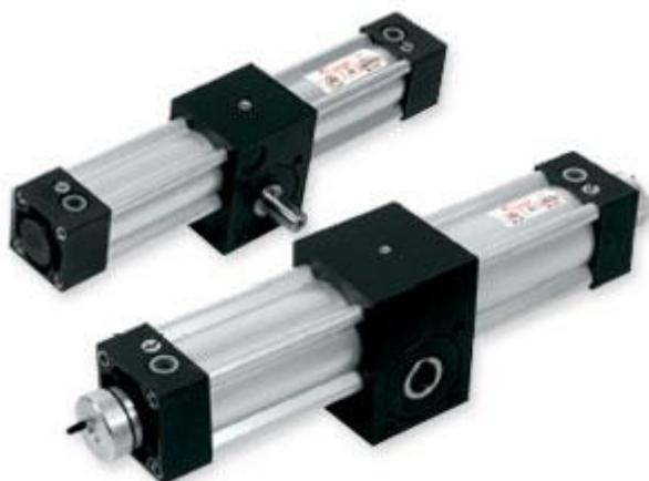
L'attuatore rotante serie CRR è un'unità che trasforma il moto lineare di un cilindro pneumatico in moto rotativo, con angolo di rotazione predeterminato dalla corsa, mediante accoppiamento cremagliera/pignone.
